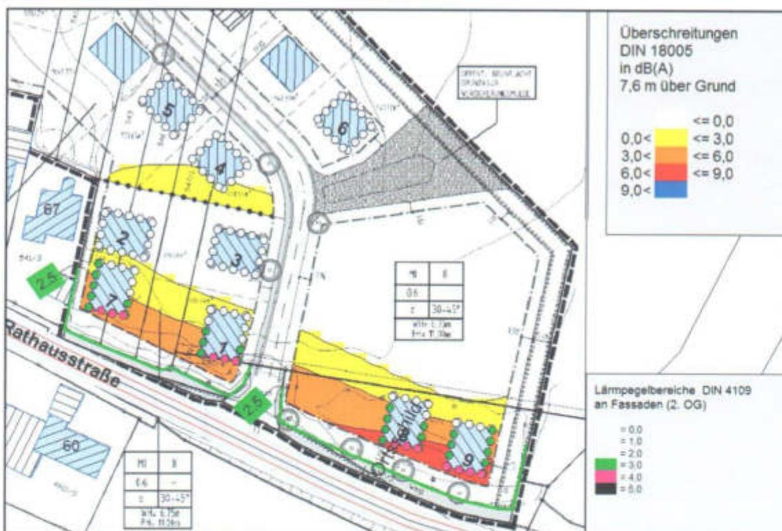
Abbildung 8: 2,5 m Lärmschutz, Überschreitungen in 7,6 m Höhe (Dachfenster)
